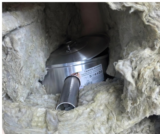
Elevernes batterier bygges op omkring en modificeret gryde
