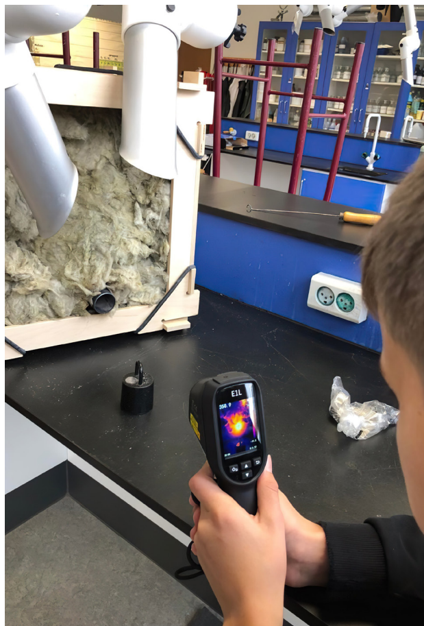
Test af termografisk kamera
